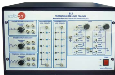
ELT Entrenador de Líneas de Transmisión
